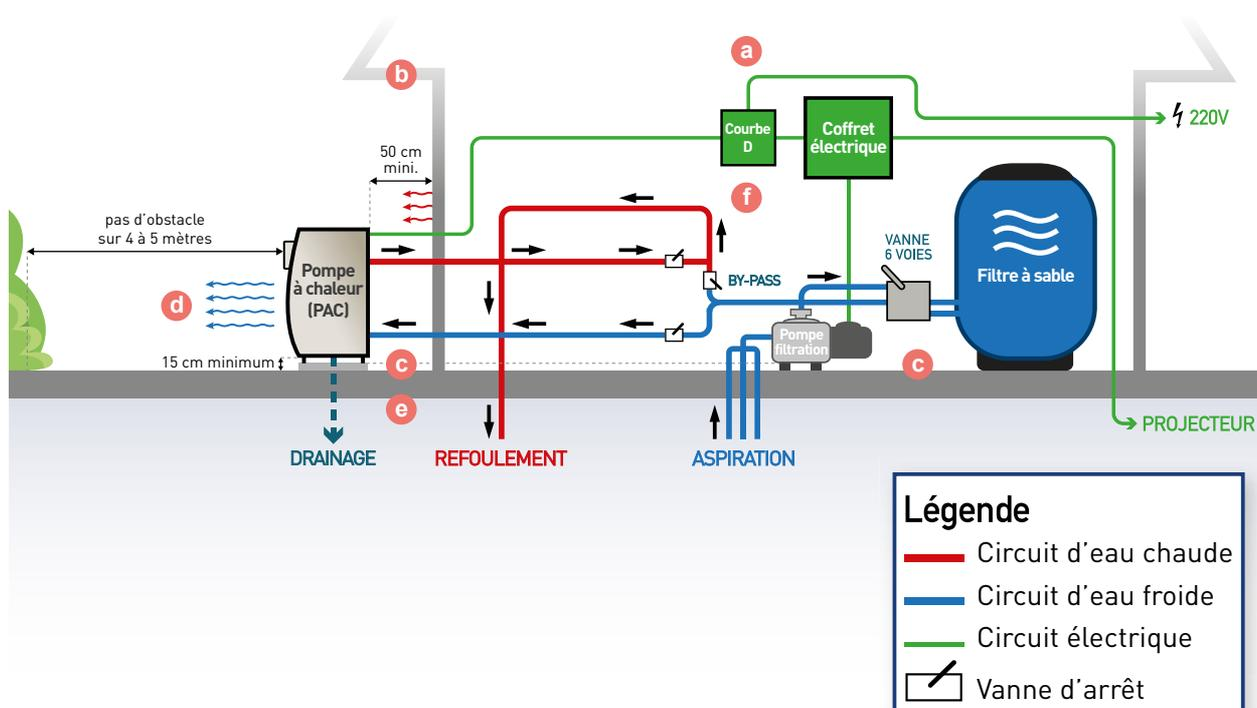
**a.** Assurez-vous que l'installation électrique soit suffisamment dimensionnée pour supporter la puissance électrique de la pompe à chaleur. L'installation d'un disjoncteur courbe D est obligatoire.
