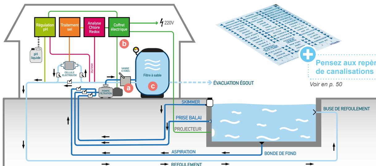
**a.** Une pompe à débit important et faible pression aspire l'eau de la piscine par 3 orifices : les skimmers, la bonde de fond et la prise balai. Un jeu de vannes à l'entrée de la pompe permet de sélectionner l'origine de l'eau.
