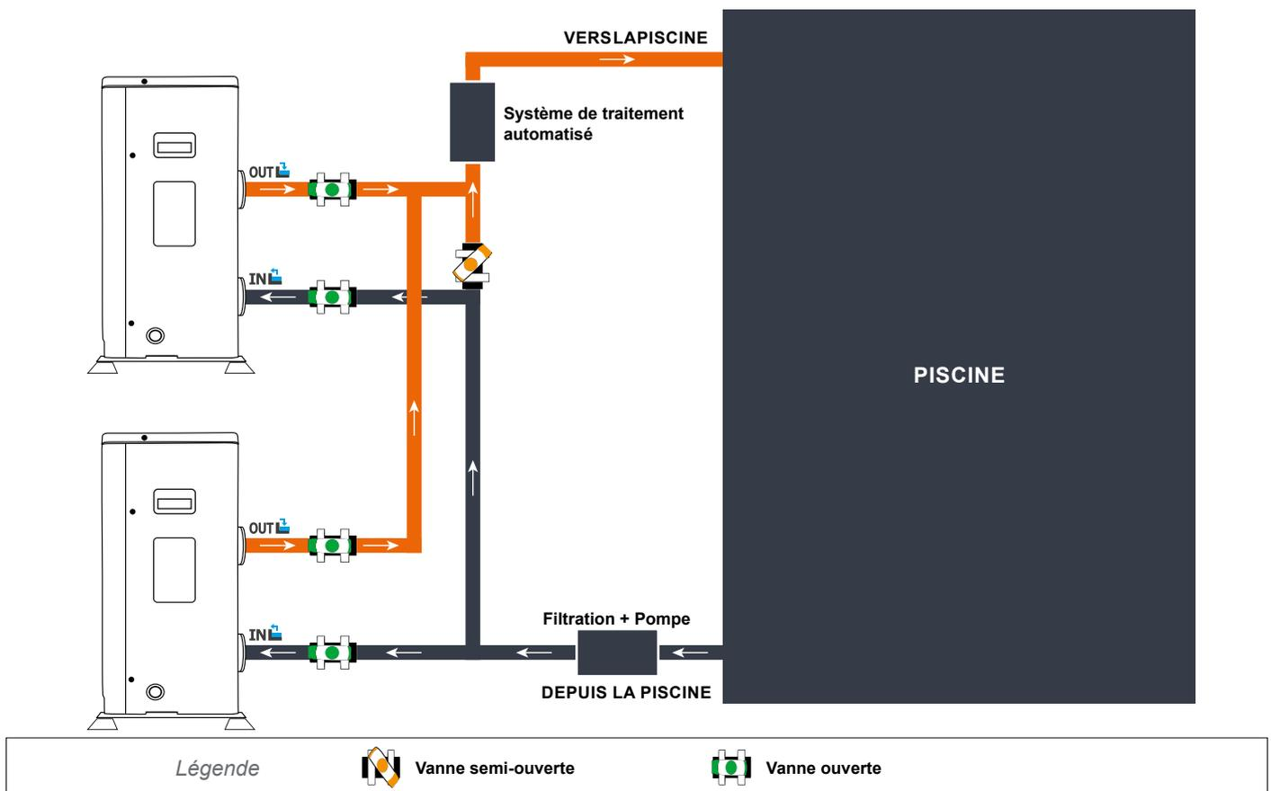
Le filtre situé en amont de la pompe à chaleur doit être nettoyé régulièrement pour que l'eau du circuit soit propre et ainsi éviter les problèmes de fonctionnement liés à la saleté ou au colmatage du filtre.
