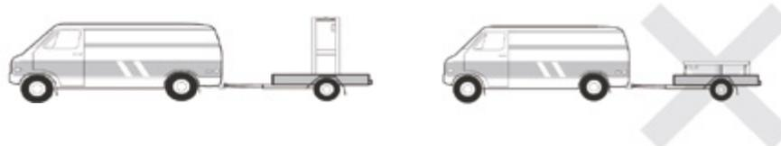
L'appareil doit toujours être stocké et transporté en position verticale sur une palette et dans l'emballage d'origine. Si l'appareil est entreposé ou transporté en position horizontale, attendez au moins 24 heures avant de le brancher.
